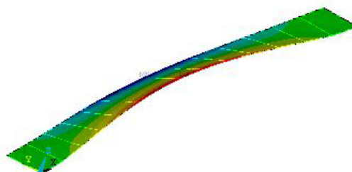
b) Modo de vibração referente à segunda frequência natural: f_{02}= 9,45 Hz.
