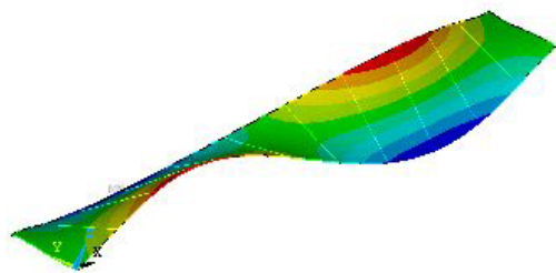
c) Modo de vibração referente à terceira frequência natural: f_{03} = 14,45 Hz.
