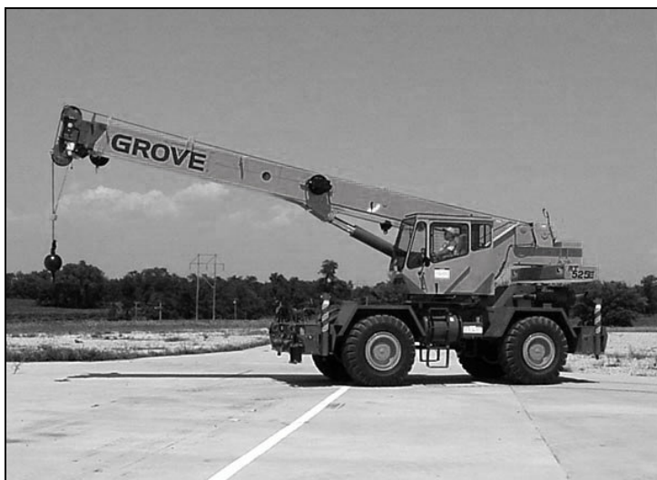
Figura 4.23 – Guindaste autopropelido Grove RTE 525 E
