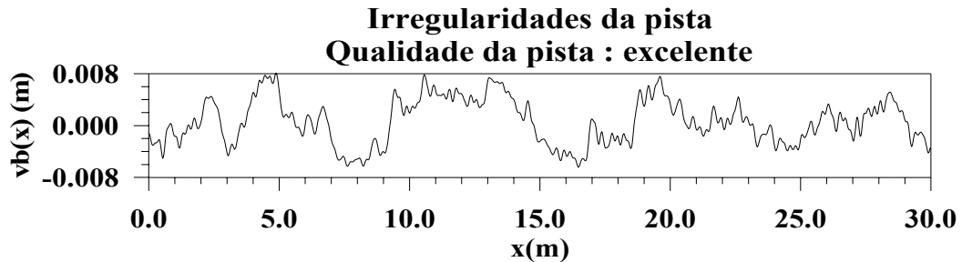
Figura 4.9 – Perfil de uma amostra de irregularidade; qualidade da pista: excelente; \Phi(\omega_0) = 1 \text{ cm}^3
