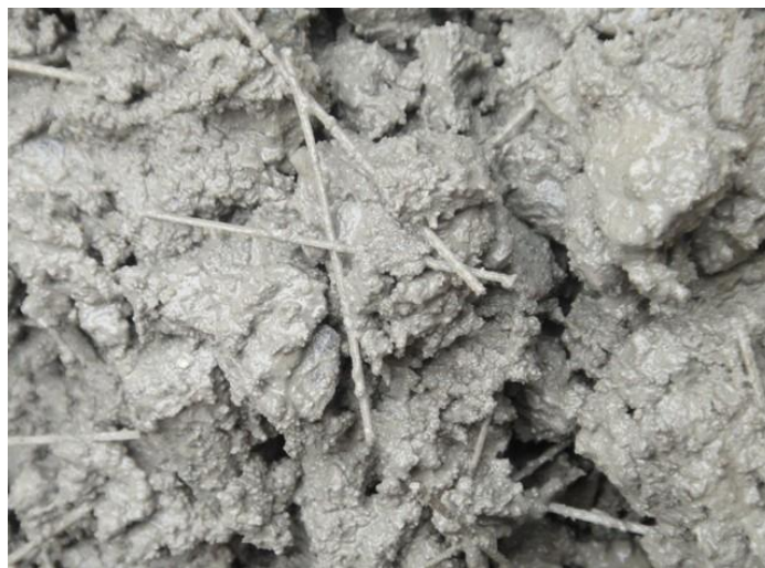
Figura 19 – Detalhe das fibras metálicas misturadas no concreto
