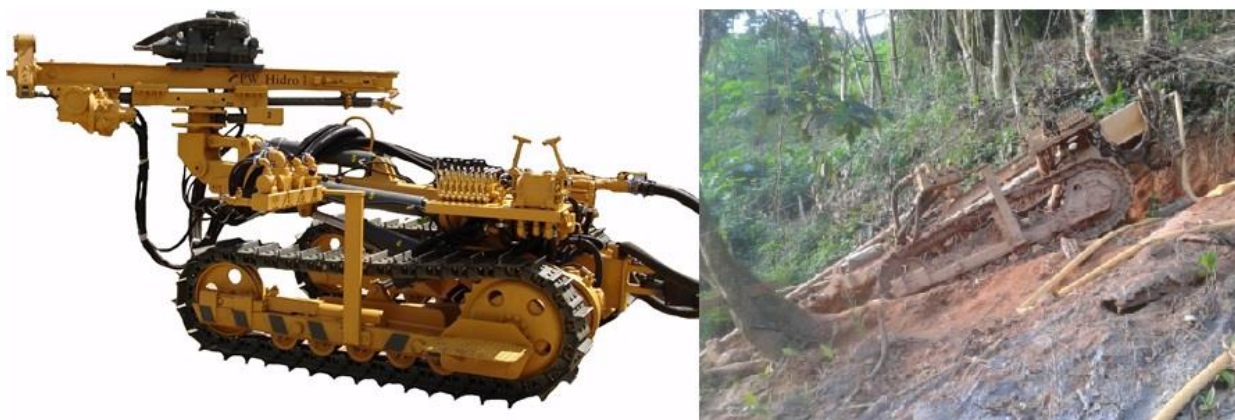
Figura 7 – Detalhe de algumas perfuratrizes utilizadas para execução do furo
