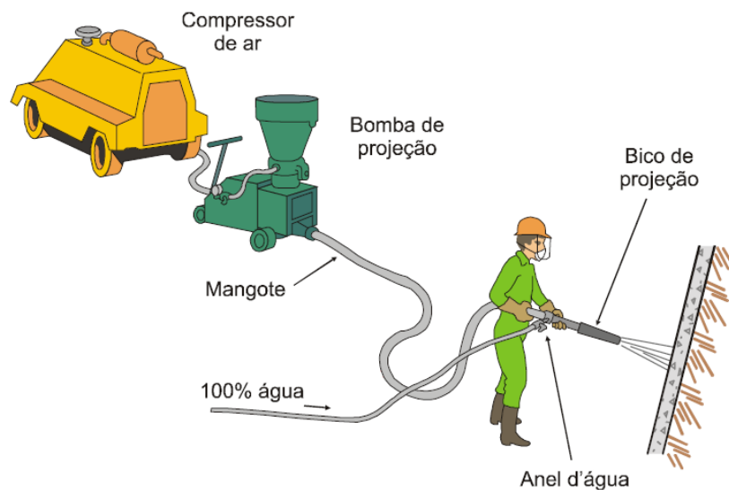
Figura 16 – Execução do concreto projetado
