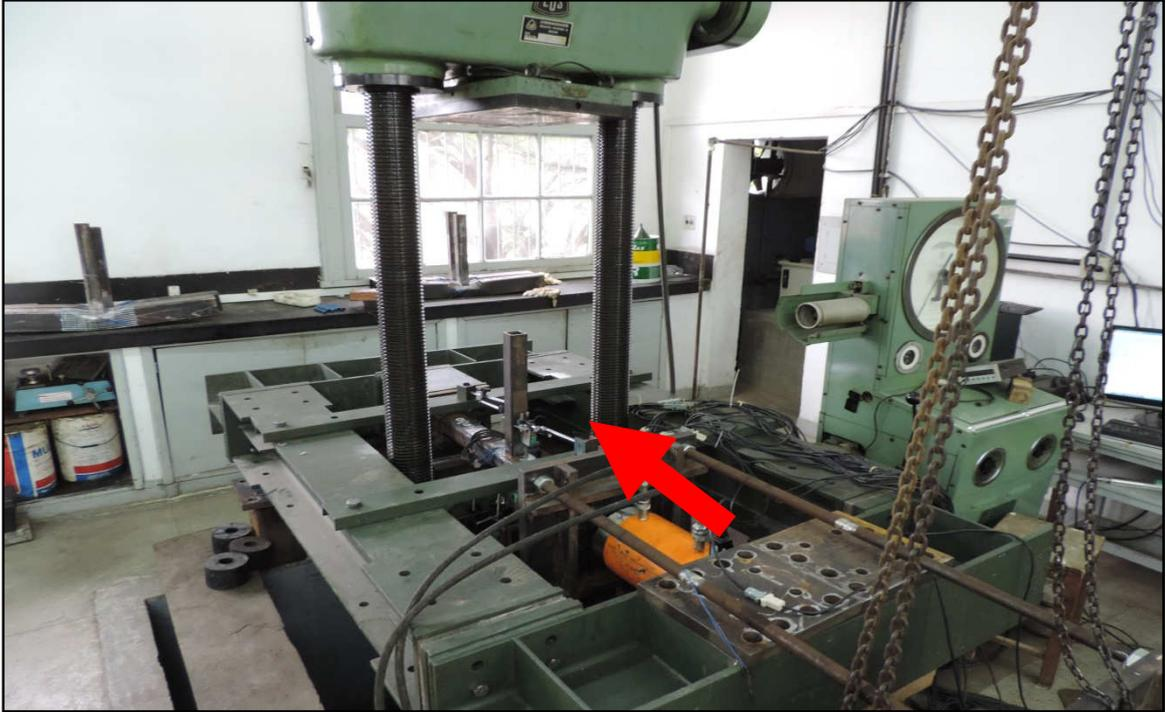
Figura 21 – Posição de instalação do macaco hidráulico permitindo a aplicação do esforço axial de compressão no banzo da ligação.
