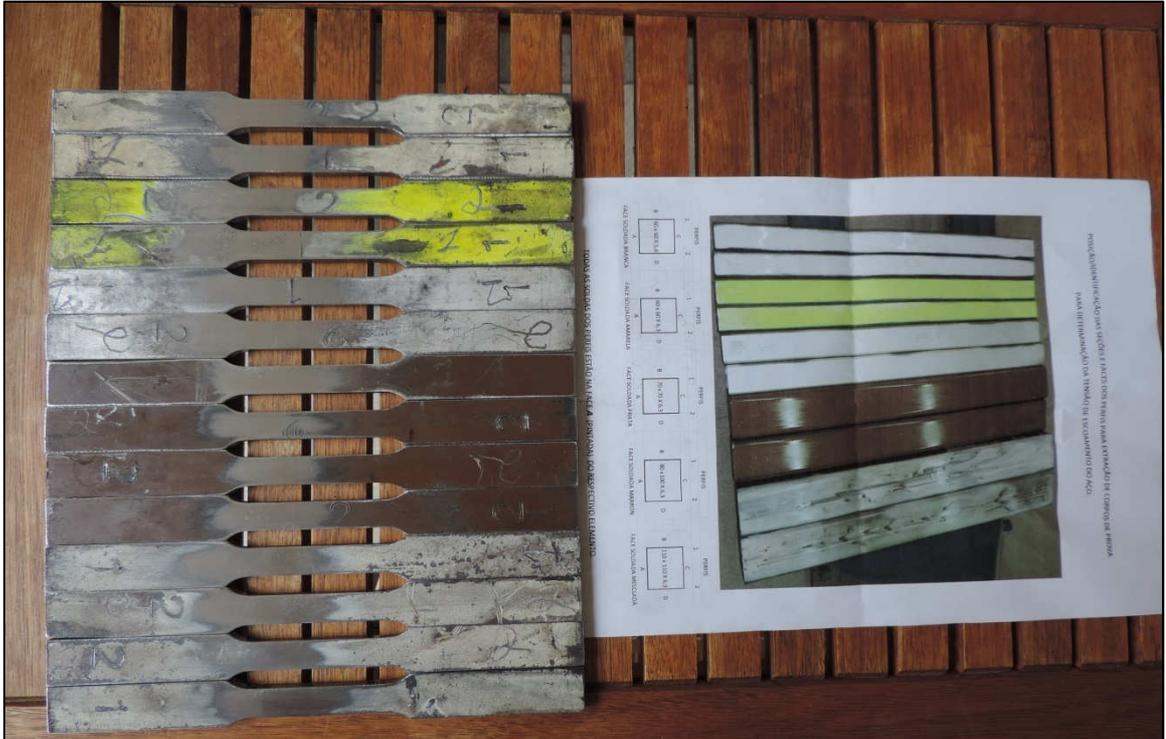
Figura 18 – Corpos de provas retirados dos perfis tubulares das ligações avaliadas.
