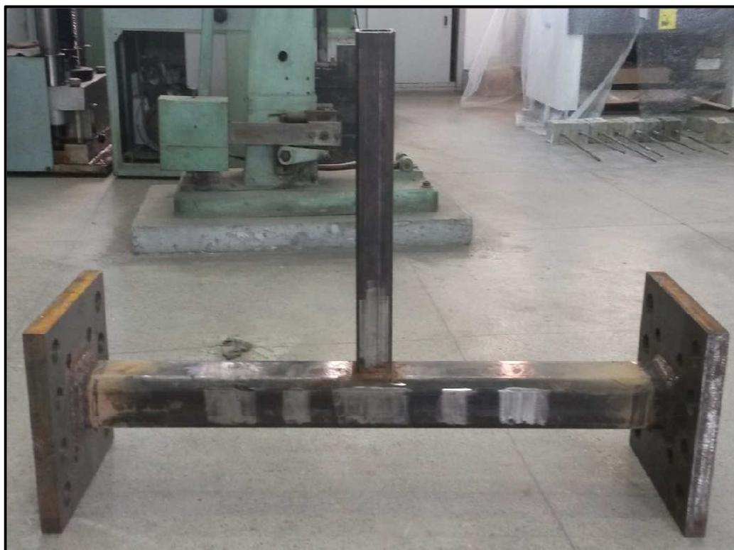
Figura 1 – Ligação tipo T (RHS de 100x80x6,3mm no banzo e SHS de 60x60x6,3mm no montante) – um dos espécimes utilizados neste estudo.
