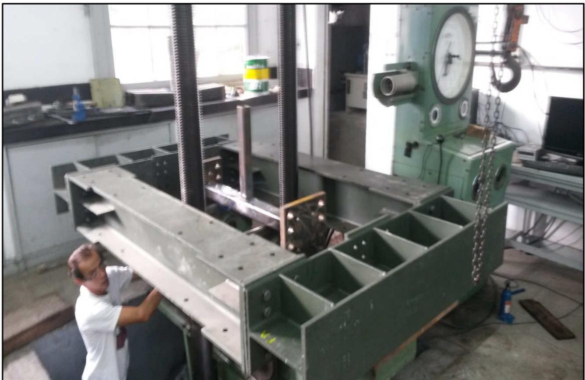
Figura 13 – Montagem do pórtico de reação utilizado nos ensaios das ligações.
