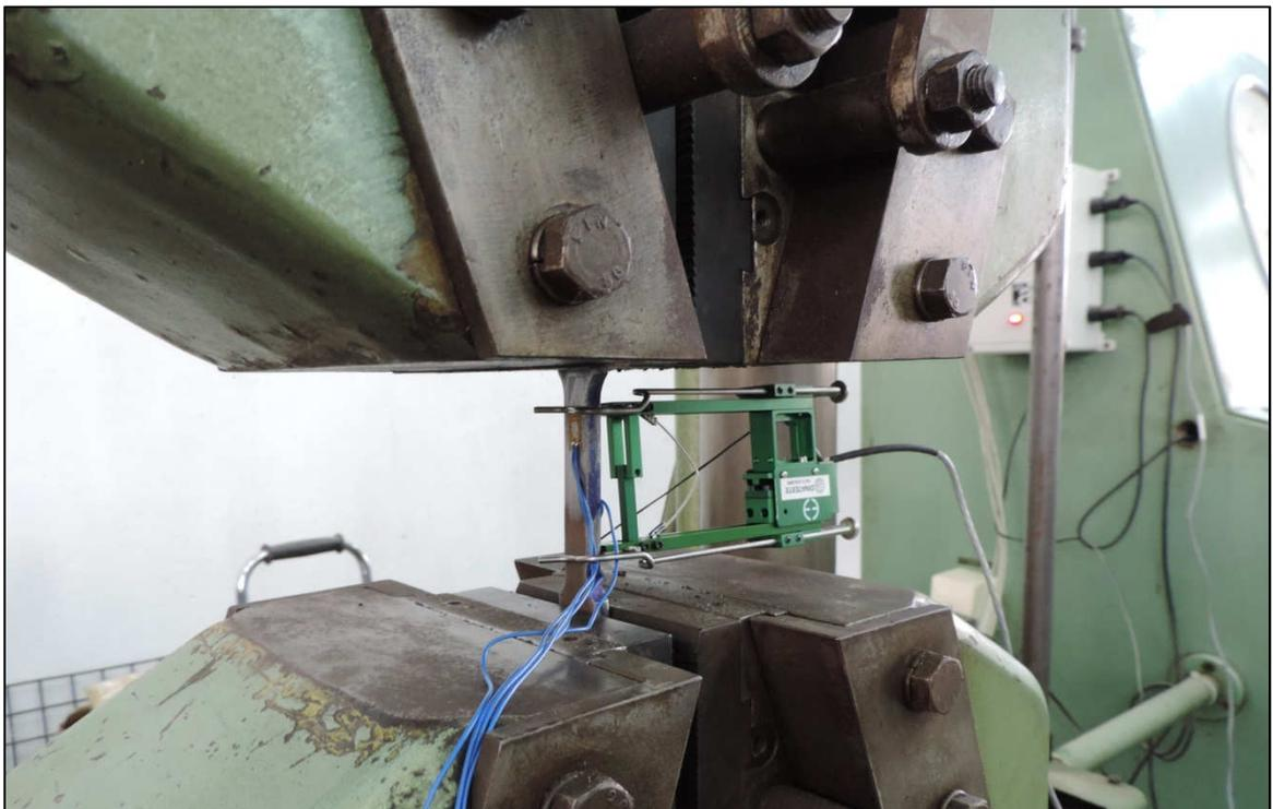
Figura 19 – Ensaio à tração nos corpos de prova.
