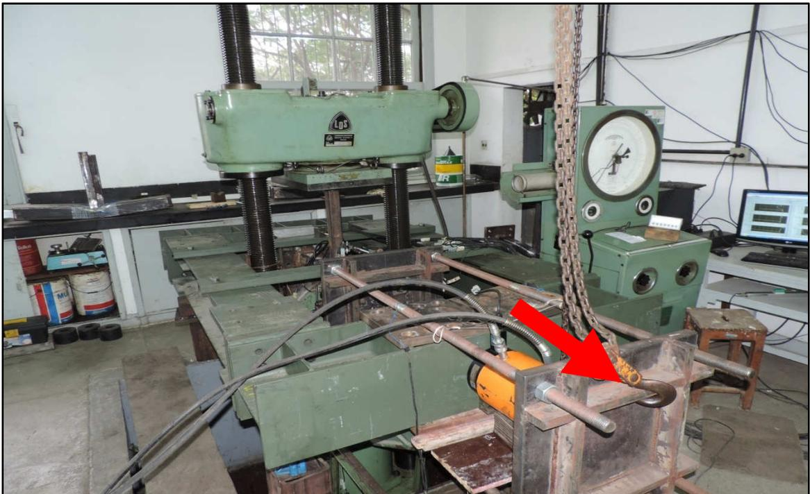
Figura 22 – Posição de instalação do macaco hidráulico permitindo a aplicação do esforço axial de tração no banzo da ligação.
