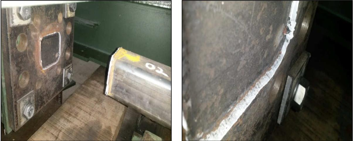
Figura 24 – Falha na solda no momento da realização do ensaio T50%TNB.
