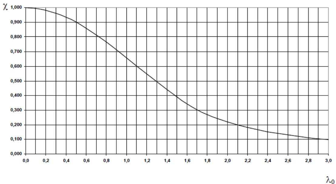
Figura 29 – Valor de  $\chi_{NBR}$  em função do índice de esbeltez  $\lambda_0$  [18]
