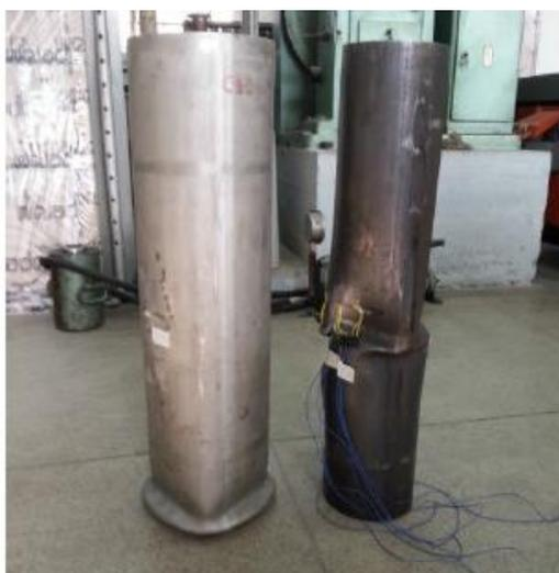
Figura 30 – Modo de flambagem dos tubos da coluna CH1-1 [14]
