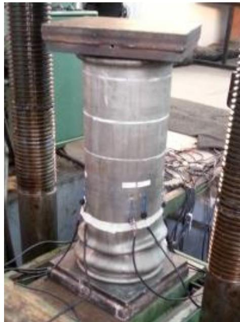
Figura 33 – Falhas observadas durante o ensaio da coluna C1-1 [14]
