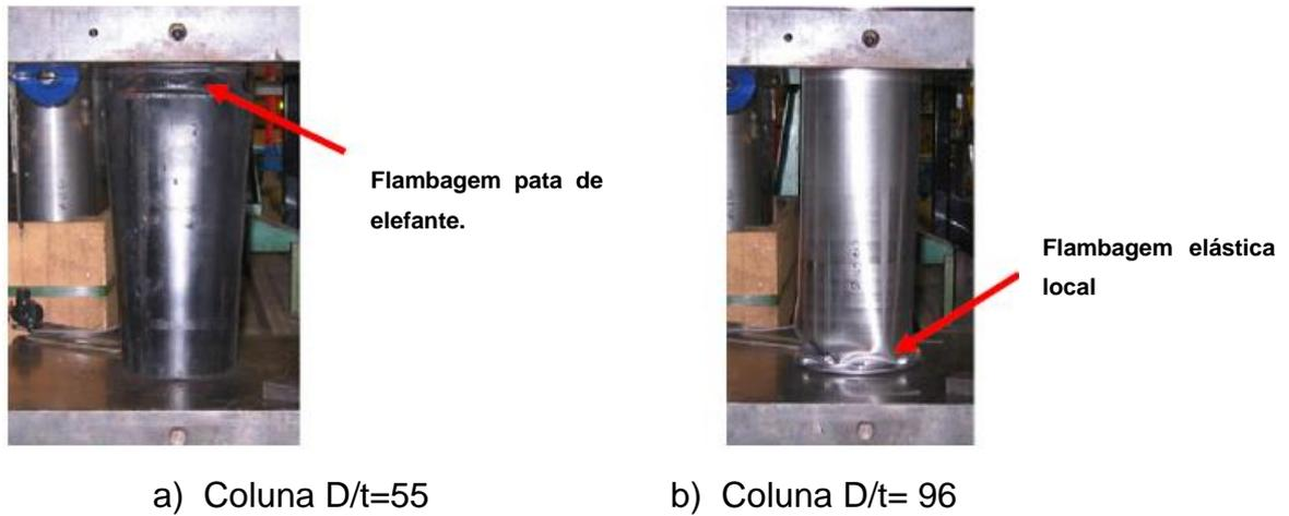
Figura 12 – Típico modo de falha para colunas com seção oca composta de perfis CHS e deformação de 100mm.
