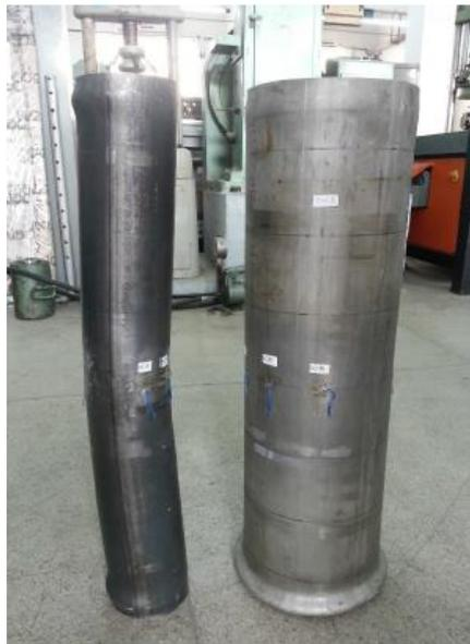
Figura 31 – Modo de flambagem dos tubos da coluna CH2-1 [14]
