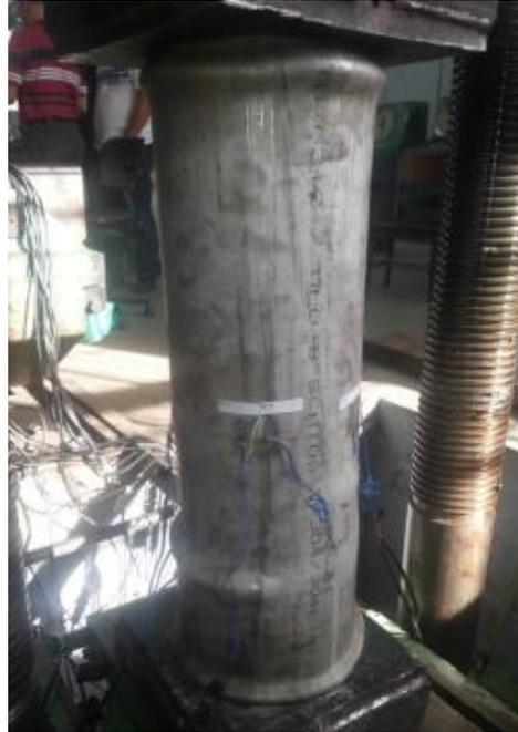
Figura 34 – Modos de flambagem observados nas colunas C2-1 e C2-1 [14]
