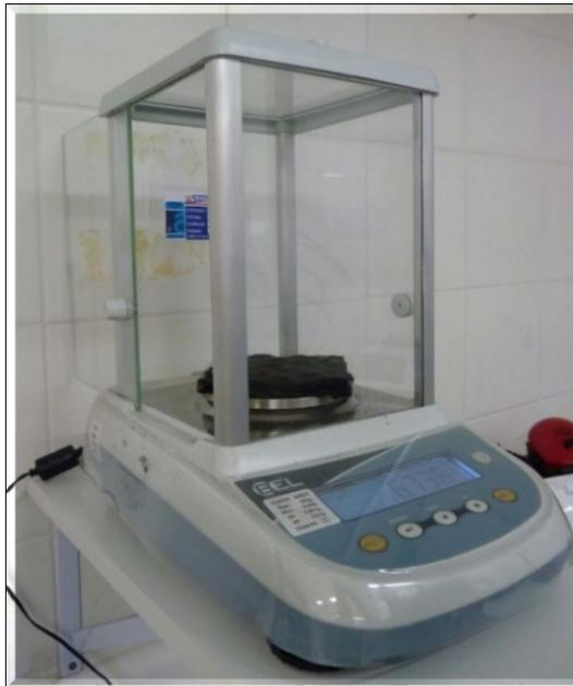
Figura 17 - Balança para ensaio de gramatura.
