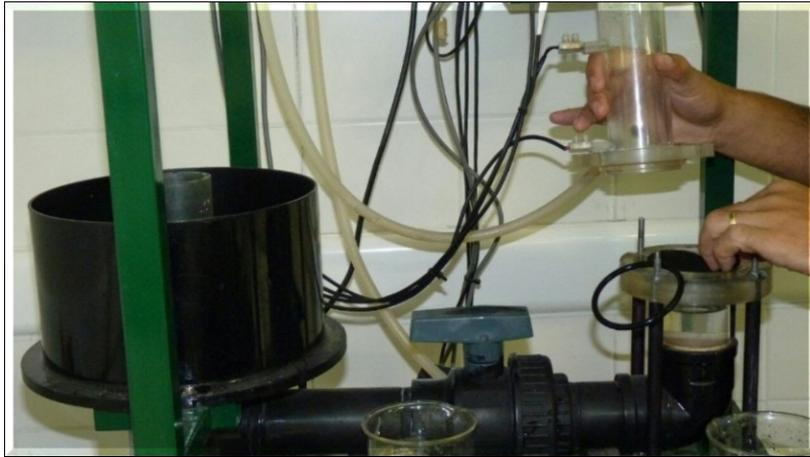
Figura 27 - Ensaio de permissividade - alocação do corpo de prova.
