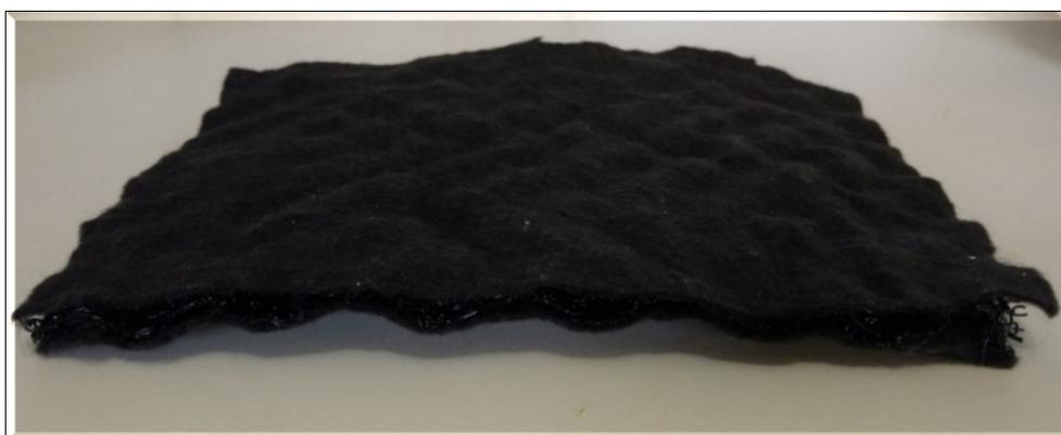
Figura 13 - Amostra geocomposto drenante MacDrain 2L.
