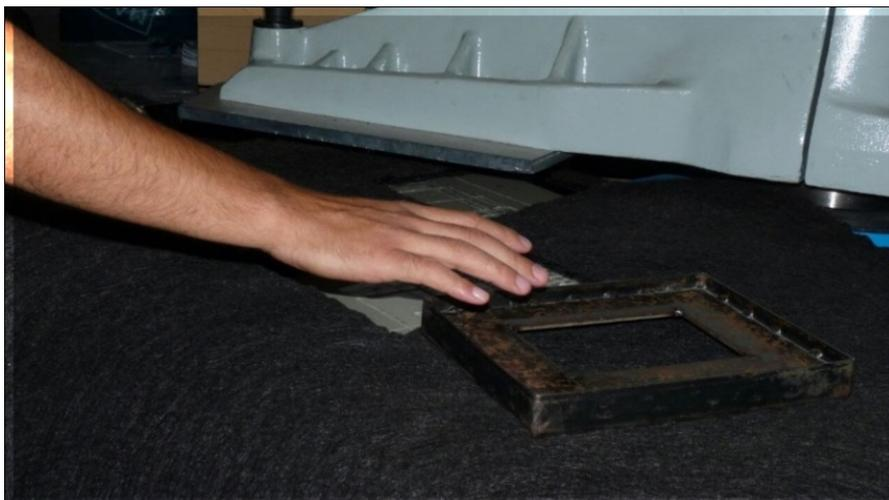
Figura 14 - Corte dos corpos de prova.
