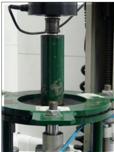
Figura 25 - Execução do ensaio de puncionamento.
