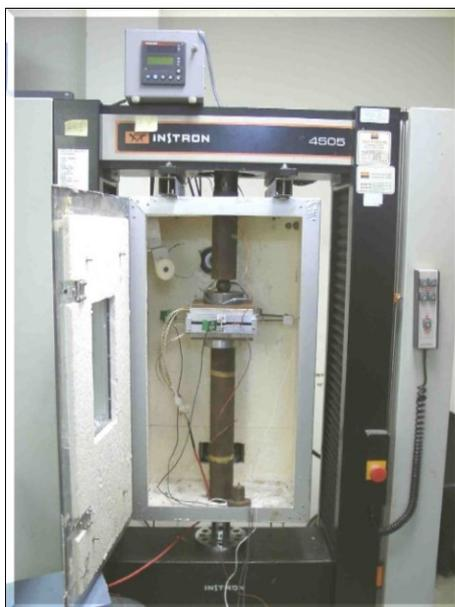
Figura 32- Equipamento para ensaio de fluência à compressão - Cortesia TRI Ambiental do Brasil
