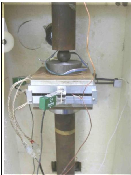
Figura 35 - Ensaio de fluência SIM à compressão - Cortesia TRI Ambiental do Brasil.
