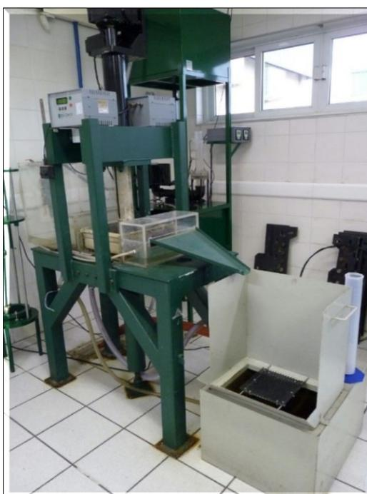
Figura 28 - Equipamento para ensaio de transmissividade.
