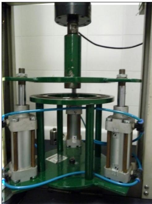
Figura 23 - Equipamento para ensaio de puncionamento.
