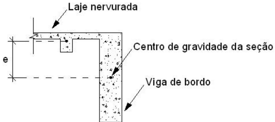
**Figura 3.8 – Visualização da excentricidade existente entre a viga de bordo e a laje nervurada**
