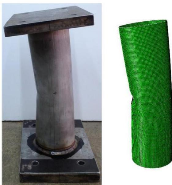
Figura 14 - Comparação entre o Resultado Experimental e Numérico[22]
