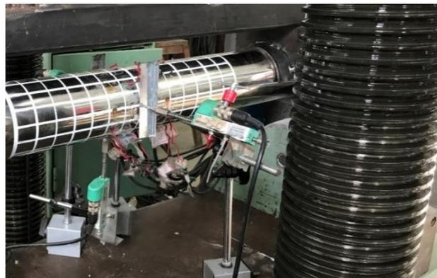
Figura 42—Posicionamento dos LVDTs nos ensaios de vigas
