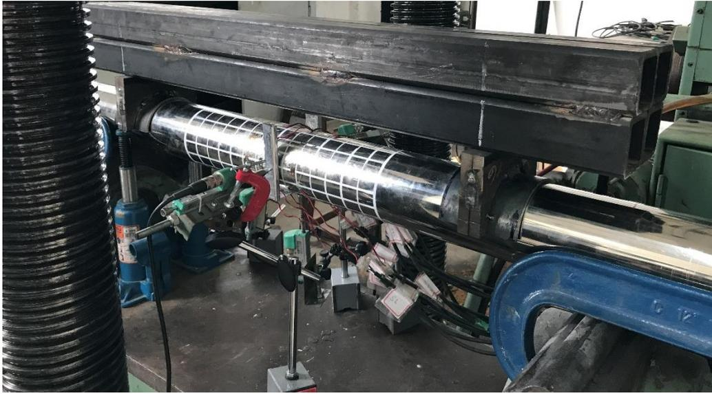
Figura 37 – Ensaio experimental a flexão pura
