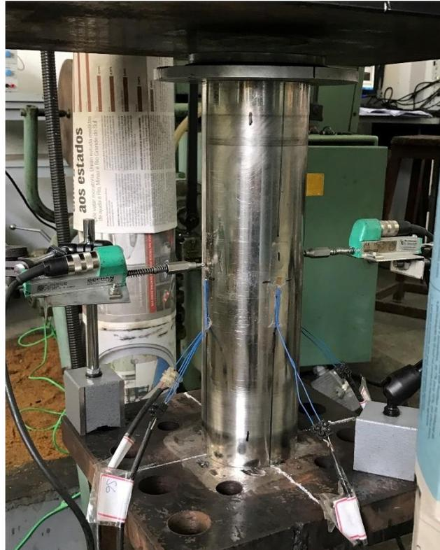
Figura 34 – Esquema estrutural para ensaios de colunas
