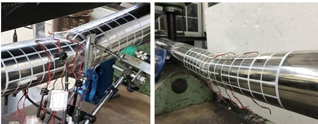
Figura 53 – Flambagem local e ovalização da seção transversal da viga
