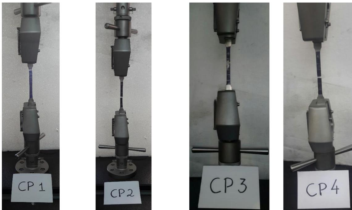
Figura 31 - Corpos de prova rompidos
