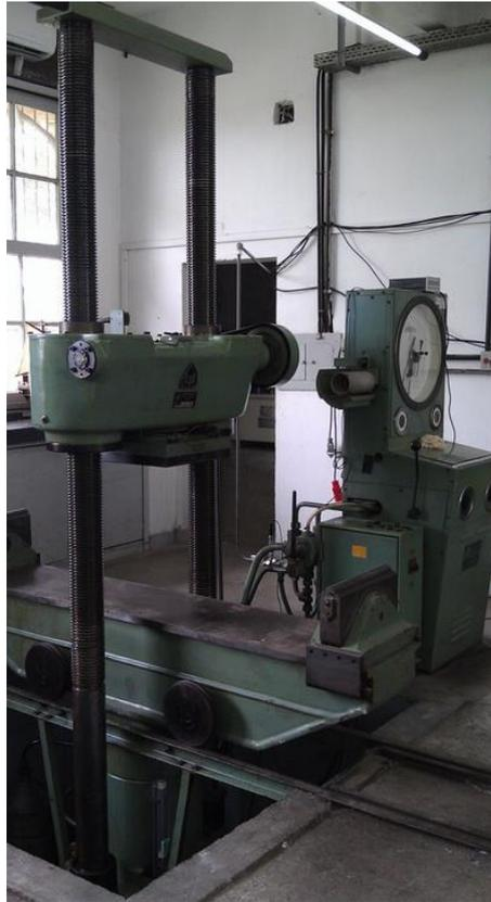
Figura 32– Máquina de Ensaios da Losenhausenwerk
