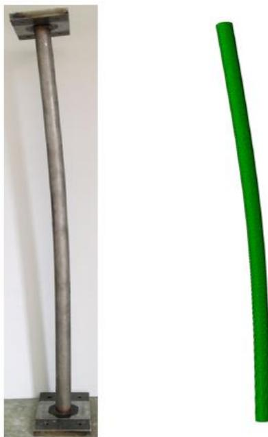
Figura 13 - Resultados experimental e numérico – Flambagem por flexão [20]
