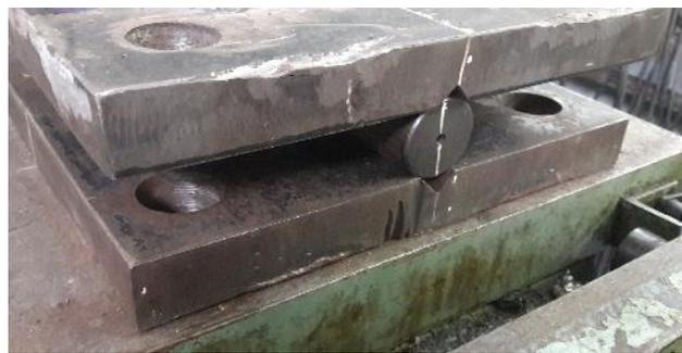
Figura 33 – Placa com chanfro e rolo móvel
