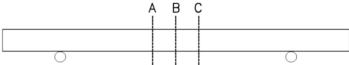
Figura 40 – Seções de instrumentação do ensaio experimental da viga
