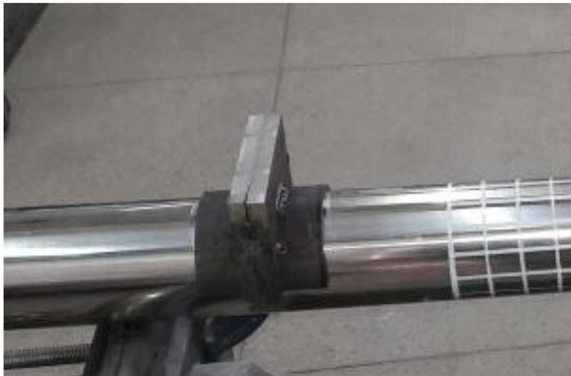
Figura 38 - Apoio da viga de transferência de carga
