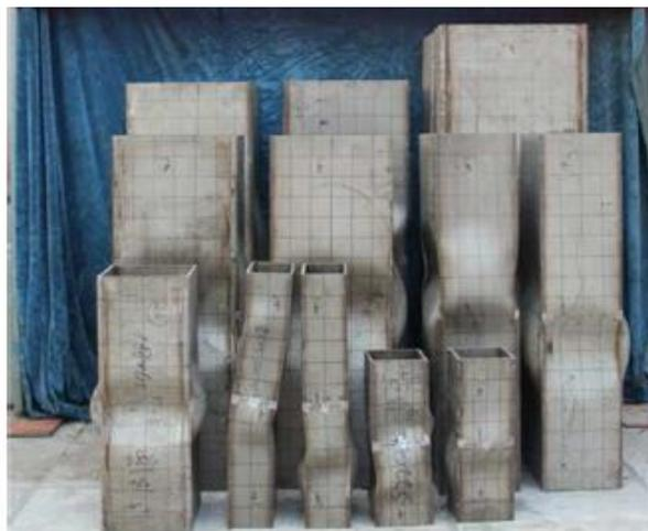
Figura 6 – Deformadas das colunas ensaiadas [9]
