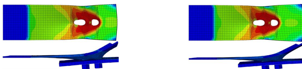
(a) EC-2F-F-L80-E55 (b) EC-2F-F-L80-E70 (VS+VL) (VS+VL) Figura 71 – Estudo de casos com dois furos, ferrítico e largura de 80 mm.
