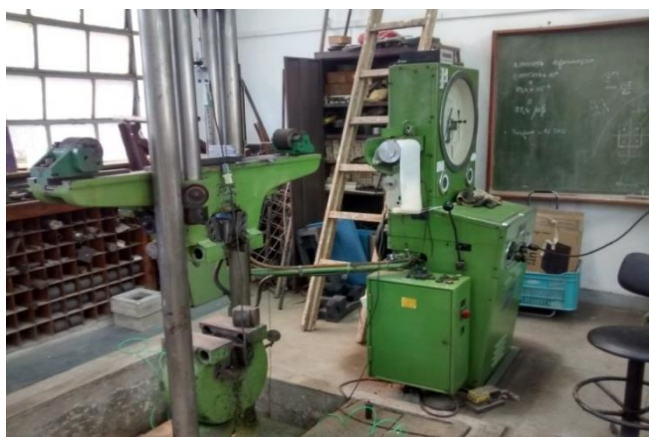
(b) Máquina universal de ensaios Lousenhausen de 600kN
