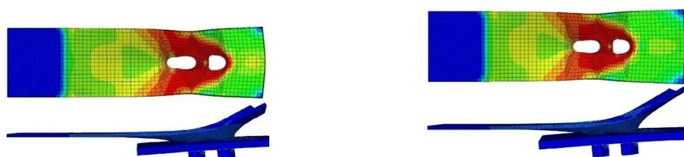
(a) EC-2F-F-L70-E55 (b) EC-2F-F-L70-E70 (VS+VL) (VS+VL) Figura 70 – Estudo de casos com dois furos, ferrítico e largura de 70 mm.
