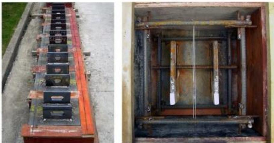
**Figura 14 – Corpos de prova com variação nos furos do conector (Zheng *et al.*, 2015).**
