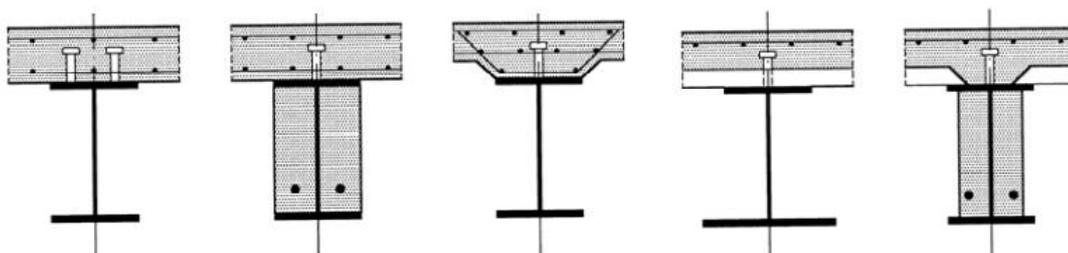
**Figura 3 – Tipos de seções transversais de vigas mistas (Eurocode 4, 2001).**
