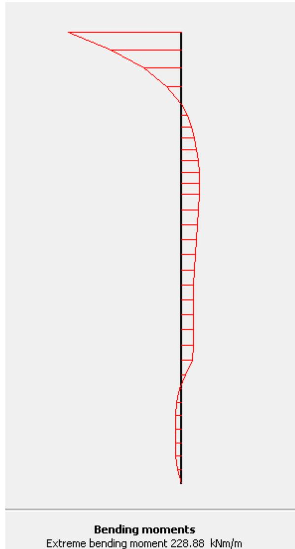
Figura 38 – Representação gráfica do momento fletor da estaca lado terra – Momento fletor máximo = 228,9 kN.m/m
