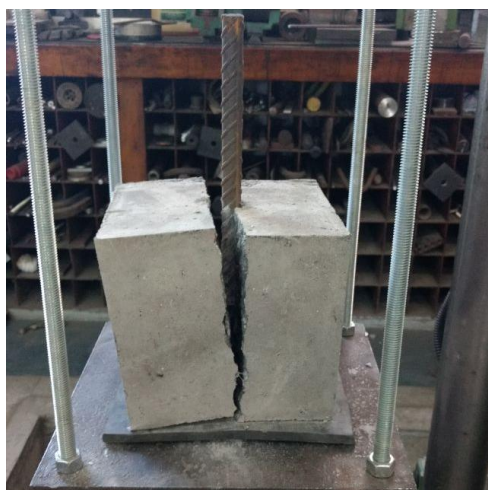
Figura 33 - Fendilhamento do concreto
