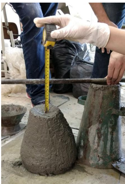
Figura 29 - Teste de abatimento "slump test"
