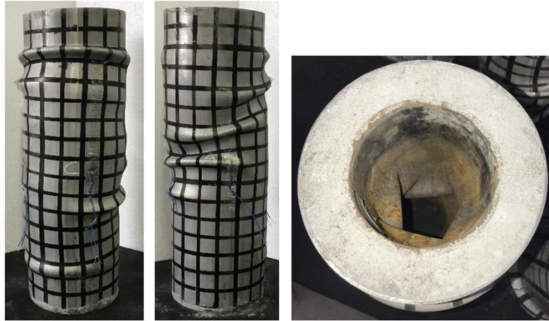
Figura 54 – Modos de falha da coluna C6
