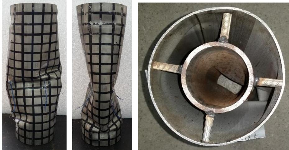
Figura 41 – Modos de falha da coluna CH1
