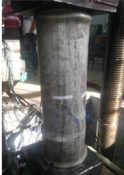
Figura 23 – Modos de flambagem observado na coluna C2-1 [7]
