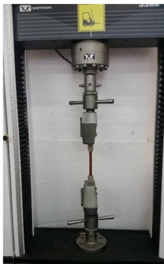
Figura 33 – Ensaio de tração realizado na máquina INSTRON 3382
