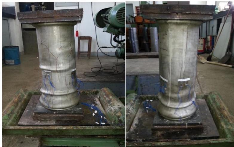
Figura 22 – Modos de falhas da coluna C1-2 [7]
