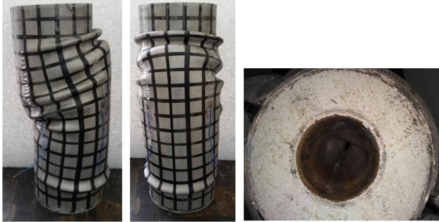
Figura 47 – Modos de falha da coluna C3
