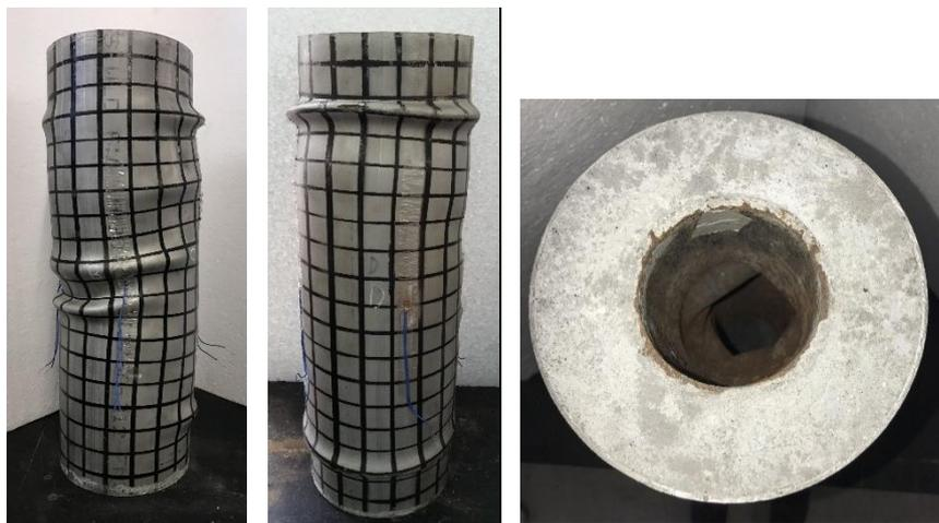
Figura 51 – Modos de falha da coluna C5
