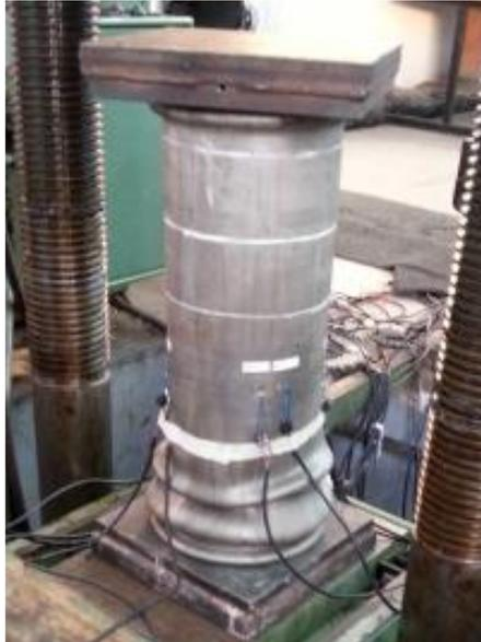
Figura 21 – Modos de falhas da coluna C1-1 [7]
