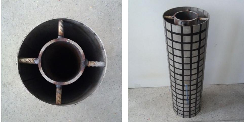
Figura 31 – Posicionamento dos espaçadores entre os tubos
