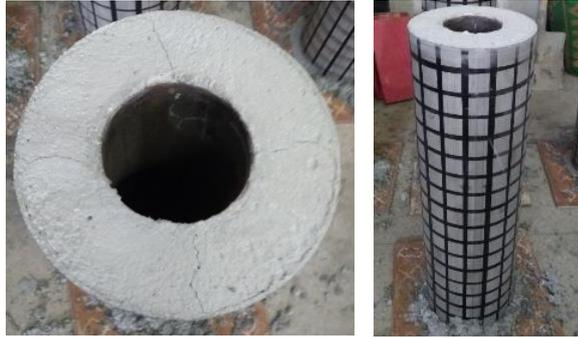
Figura 35 – Coluna CFDST após a concretagem
