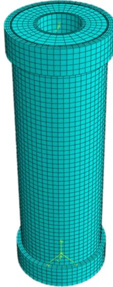
Figura 58 – Distribuição da malha das colunas CFDST
