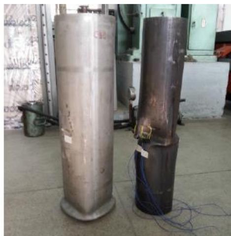
Figura 19 – Modo de flambagem dos tubos da coluna CH1-1 [7]
