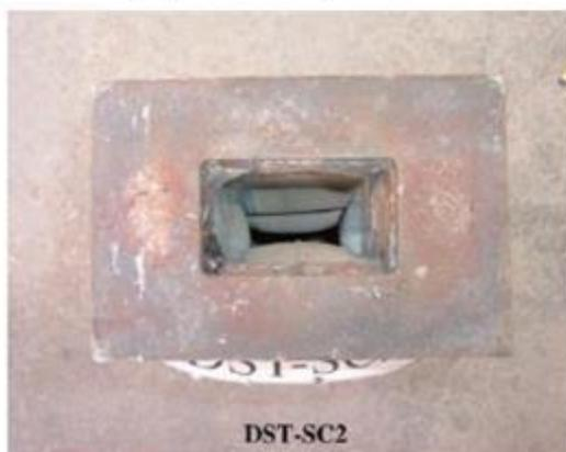
(b) Modo de falha do tubo interno de perfil RHS
