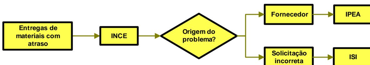
**Figura 4.11 – Indicadores utilizados para entrega de materiais com atraso para o fornecimento de concreto.**
