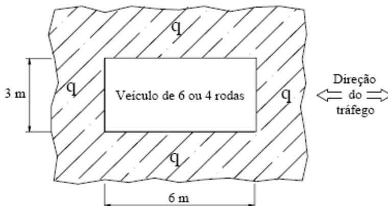
**Figura 6.3 – Trem tipo da NBR 7188 [34]**
