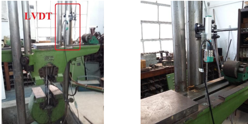
Figura 31 – Instrumentação para medição do deslocamento axial
