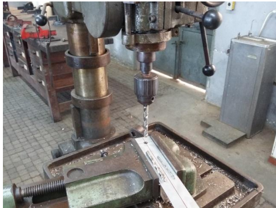
Figura 26 – Furação das placas de aço inoxidáveis
