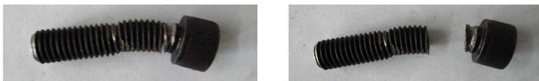
Figura 51 – Ruptura do parafuso do teste S1S-E22-L50-A3
