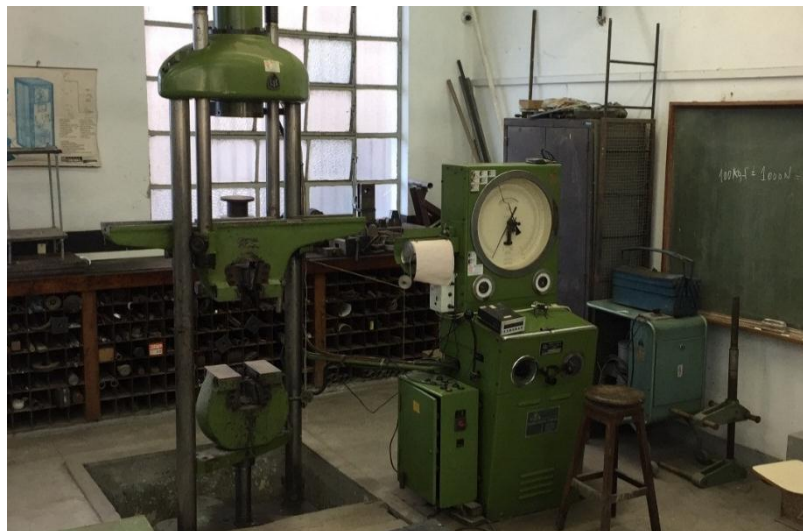
Figura 30 – Máquina Losenhausen de 600kN e sistema analógico
