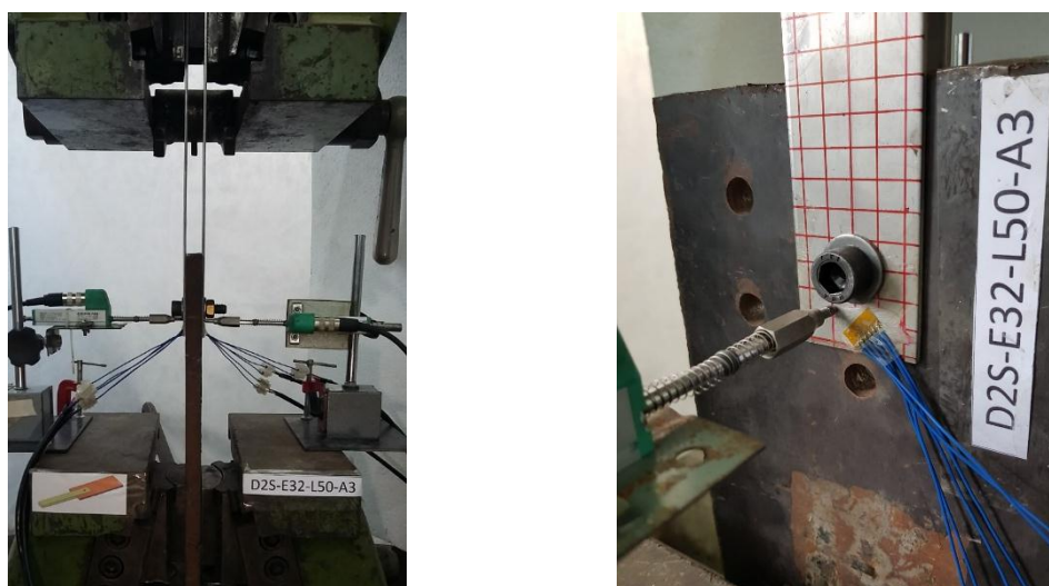
Figura 32 – Medição do efeito curling
