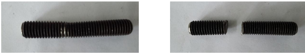
Figura 55 – Ruptura no parafuso do teste D2E-E32-L50-F3
