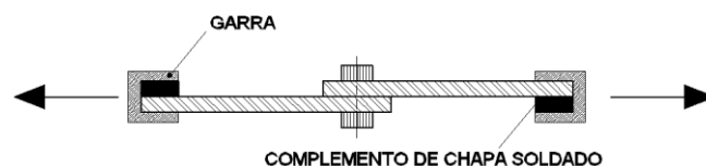
Figura 53 – Dispositivo utilizado para evitar excentricidades adicionais dos testes S1S e S2S
