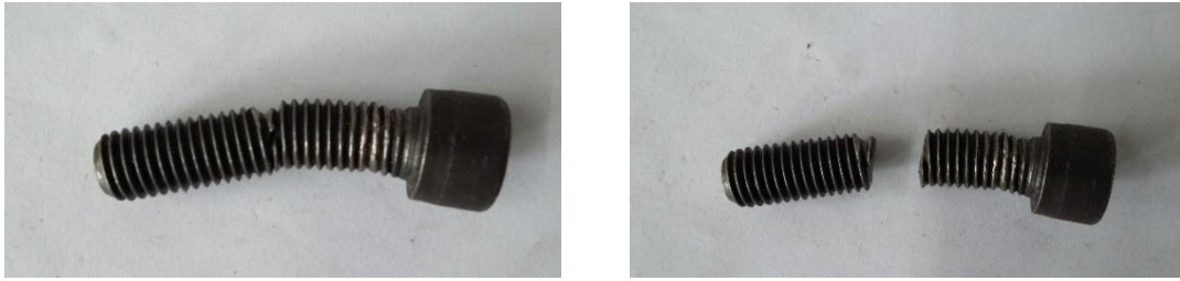
Figura 39 – Ruptura do parafuso do teste D2S-E32-L50-A3
