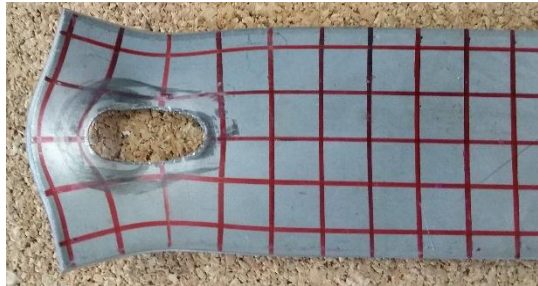
Figura 52 – Deformada após ruptura do teste S1S-E22-L50-A3
