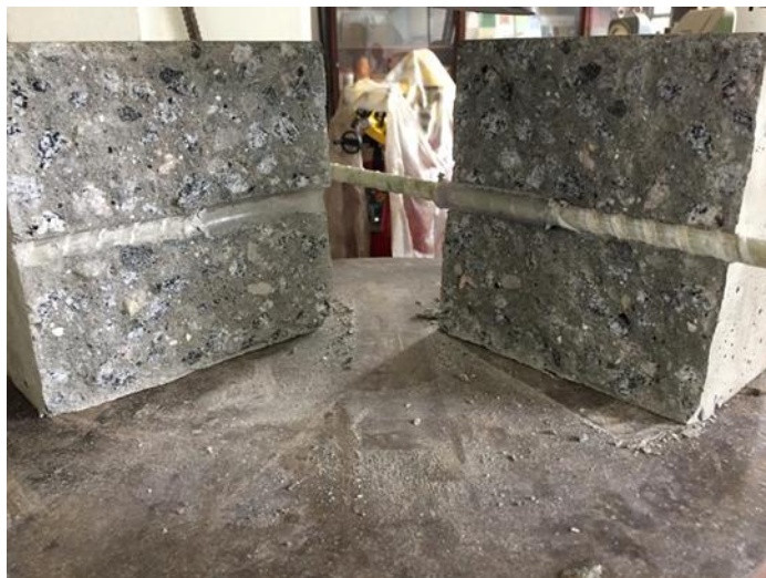
Figura 54-Ruptura por arrancamento, com esmagamento da nervura e pó residual no concreto.
