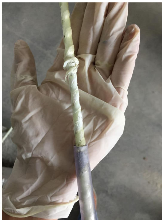
Figura 53- Destruição da nervura devido a ruptura por arrancamento.
