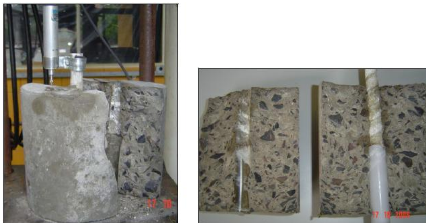
Figura 29- Ruptura combinada no ensaio de arrancamento. (COUTO, 2007)
