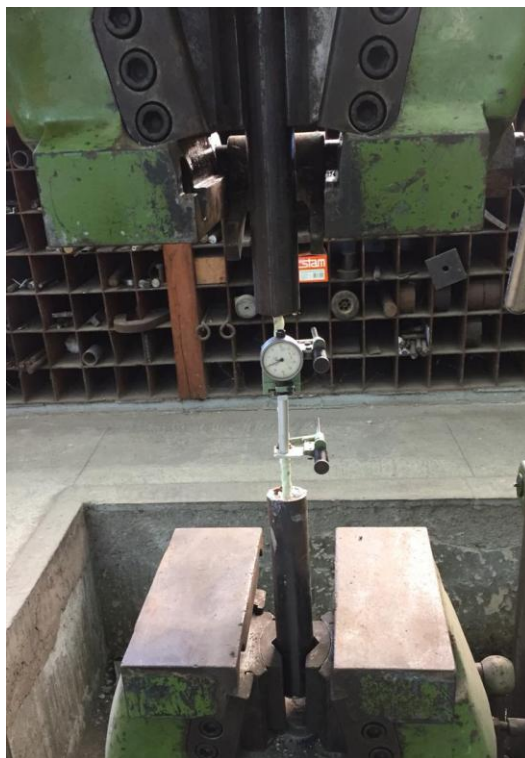
Figura 45 – Esquema de ensaio, com dispositivo de ancoragem para ensaio de tração.
