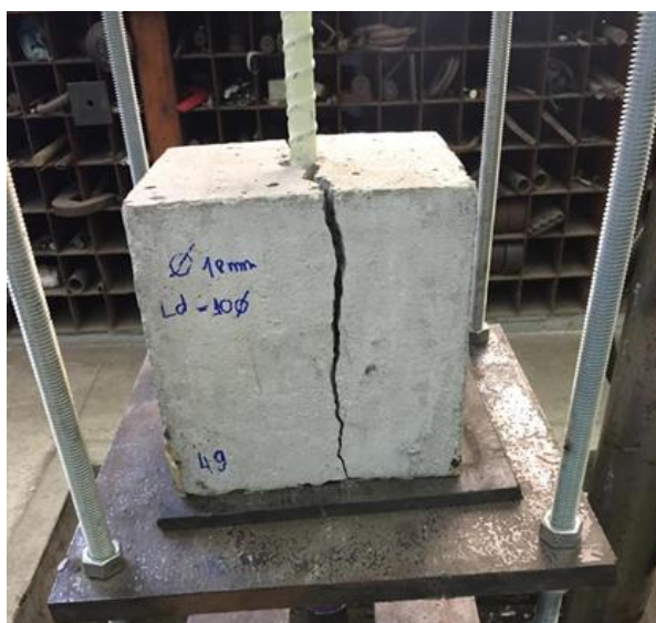
Figura 58- Ruptura por fendilhamento.
