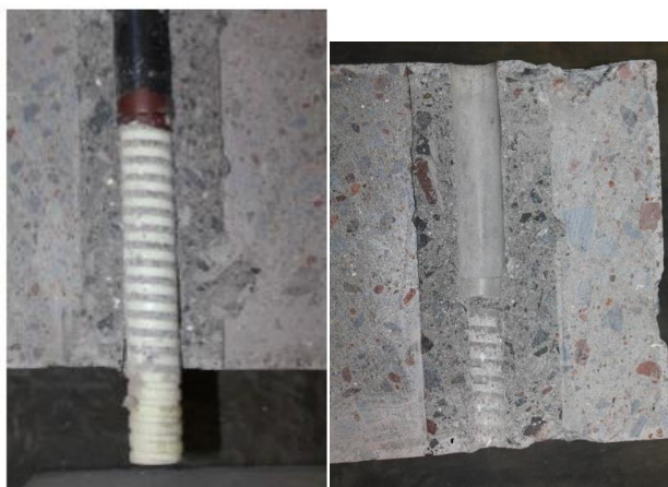
Figura 34 - Modo de ruptura dos ensaios. (GONÇALVES, 2013)
