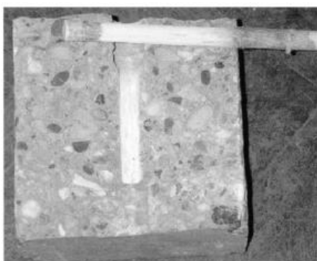
Figura 13- Modelo de arrancamento com barras de GFRP após o ensaio. (ACHILIDES E PILAKOUTAS, 2004)
