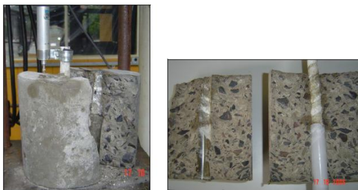
Figura 15- Ruptura por fendilhamento do concreto (COUTO, 2007).
