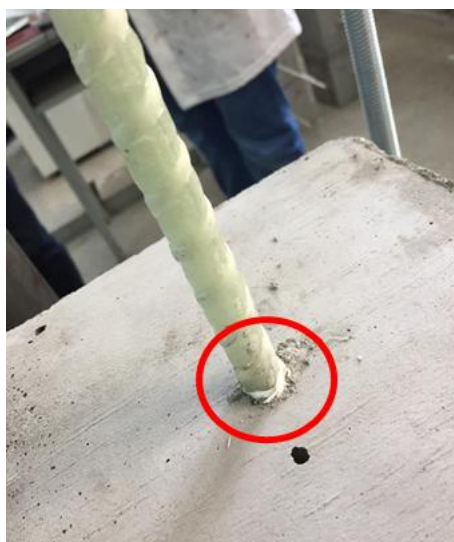
Figura 55- Excesso de nervura na superfície do bloco, caracterizando arrancamento.
