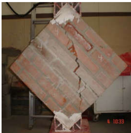
Figura 9. Ensaio de compressão diagonal em mini-painéis (Galleguillos e Valenzuela, 2009)
