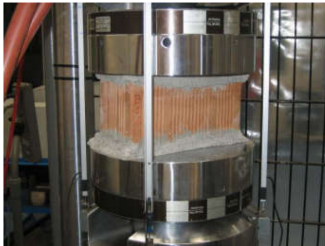
Figura 1. Ensaio à compressão simples num bloco cerâmico (Bergami, 2007)
