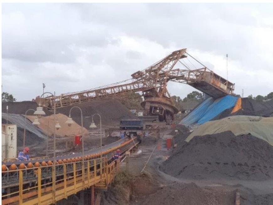
Figura 17 – Retomadora avariada ao fundo e pilhas de minério avançando próximas às margens do rio (UON, 2014)
