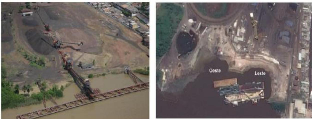
Figura 21 – Cenários antes e depois da ruptura, evidenciando os trechos Leste e Oeste, divididos pela correia transportadora (Pereira Pinto, 2017)
