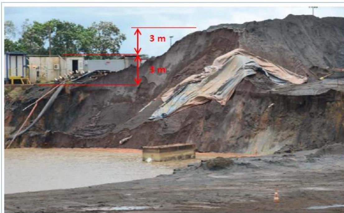
Figura 29 – Detalhe da pilha no trecho Leste, indicando que a ruptura ocorreu para uma altura de pilha de 6 m (Pacheco *et al.*, 2014)
