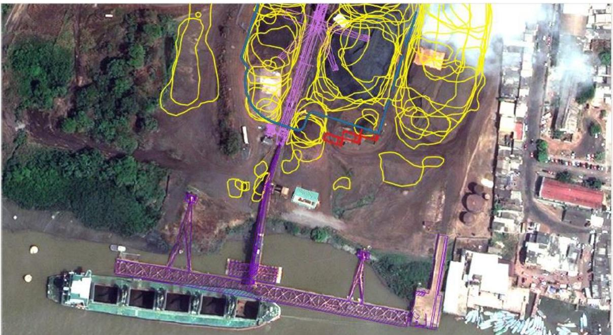
Figura 20 – Foto área do Porto de Santana com sobreposição de todas as pilhas identificadas, em amarelo. As caixas de decantação em vermelho estão posicionadas no limite do terreno resistente (Pereira Pinto, 2017)
