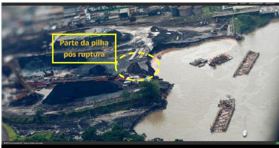
Figura 28 – Cenário pós ruptura, trechos Leste e Oeste. Destaque para parte da pilha remanescente (Pacheco et al. 2014)
