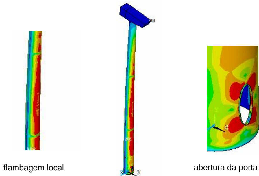
Figura 5.4 – Distribuição de tensões de Von Mises (em Pa) correspondente ao ponto 2 da Figura 5.2 – Carga aplicada de 1491,00 kN e deslocamento de 2,56 m
