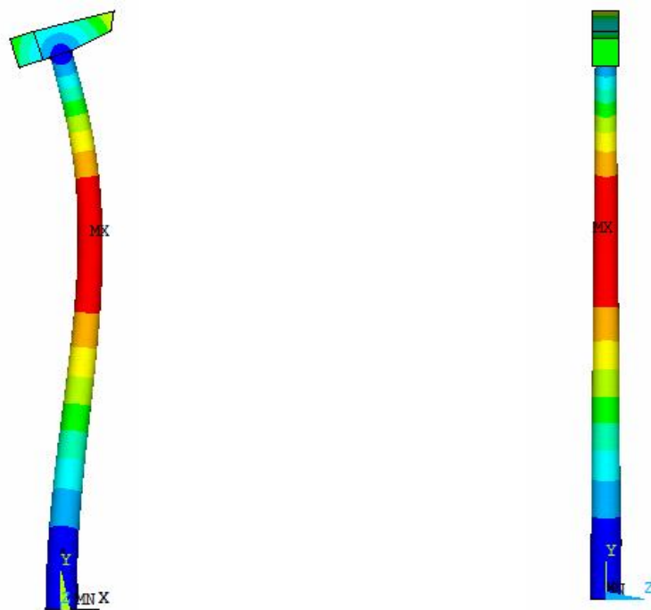
Figura 4.4 - Modo de vibração correspondente à terceira frequência natural do modelo estrutural: torção
