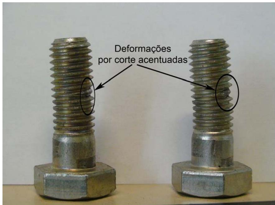
**Figura 4.36 – Corte apresentado no parafuso do ensaio E5\_INOX\_S50**
