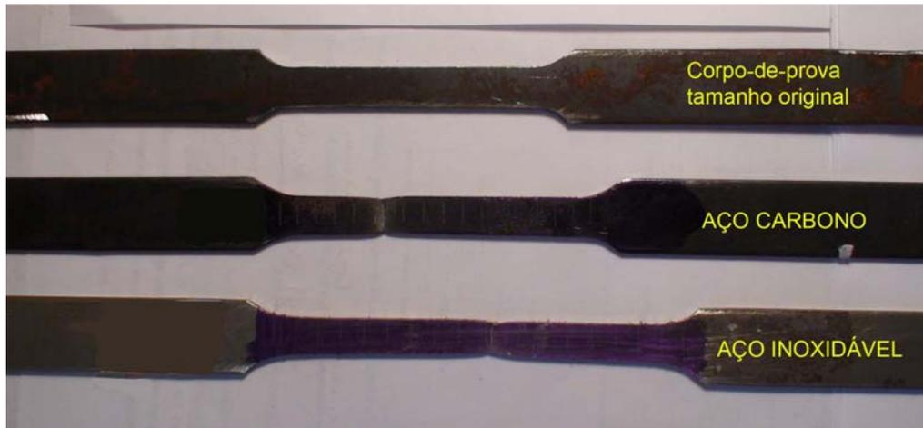
**Figura 2.10 – Ensaio de corpos-de-prova**
