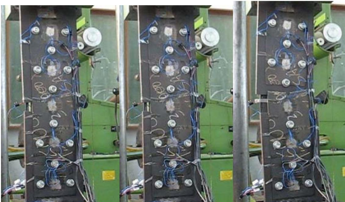
**Figura 4.23 – Seqüência de ruína do ensaio E2\_CARB\_S70\_a**
