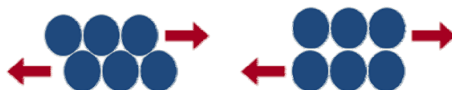
Figura 2.4. Ilustração do conceito de dilatância (Ortigão, 2007)
