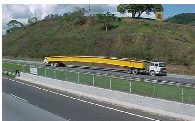
Figura 5.15 - Transporte da viga com dois tratores mecânicos
