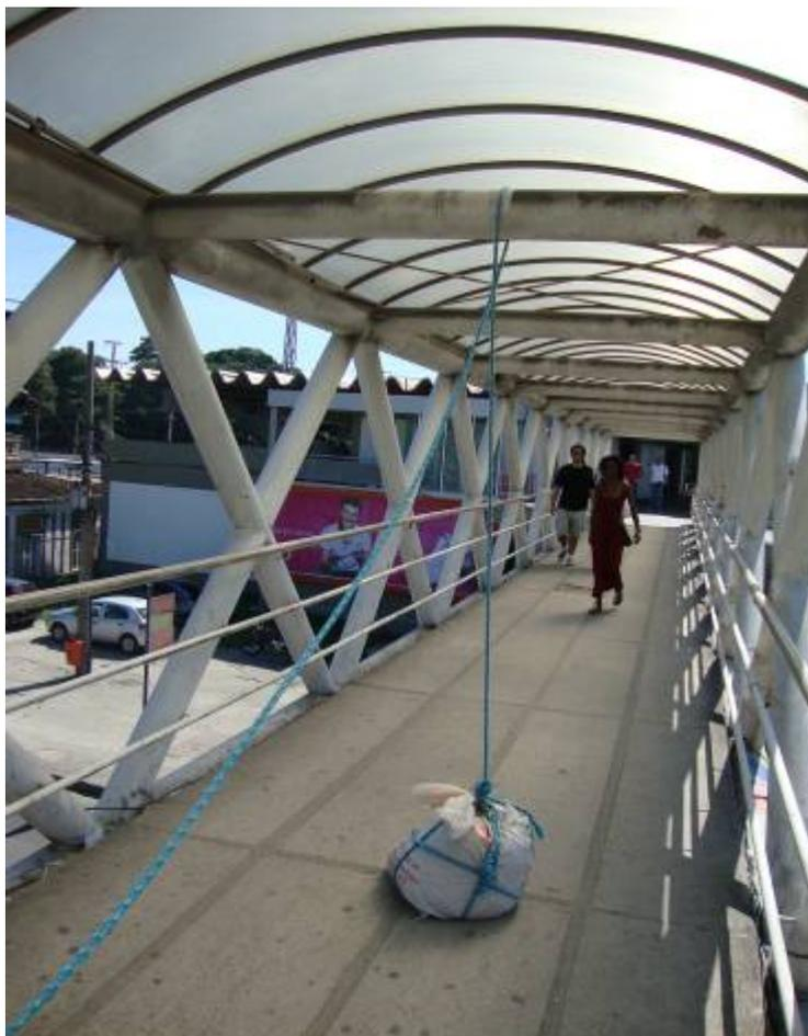
Figura 6.20 – Excitação livre da passarela observa-se a massa depois do impacto.
