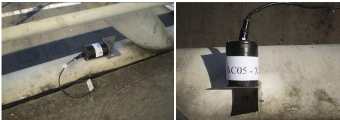
Figuras 6.17 e 6.18 – Instalação do acelerômetro na direção longitudinal e detalhe na direção transversal.
