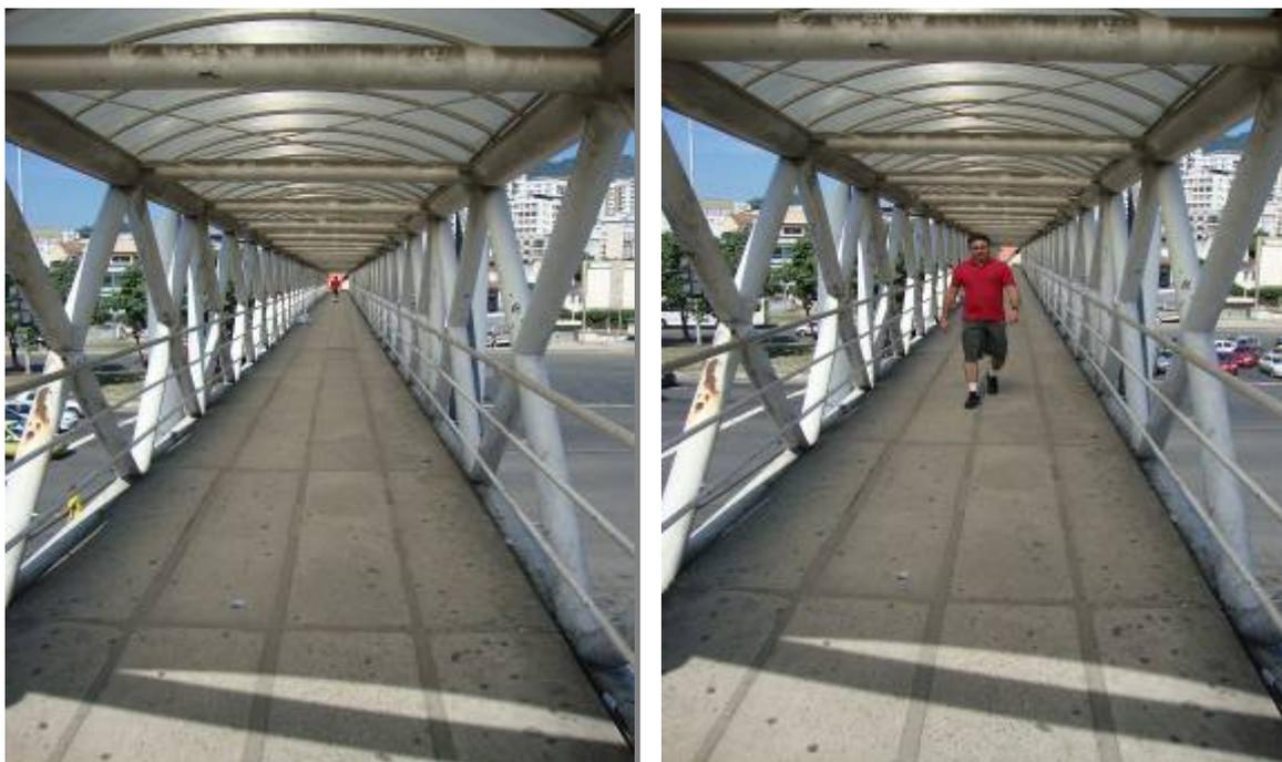
Figura 6.21 – Detalhe da excitação dinâmica induzida por uma pessoa com a passarela total livre de outros pedestres. Note-se que a caminhada foi no eixo da seção transversal
