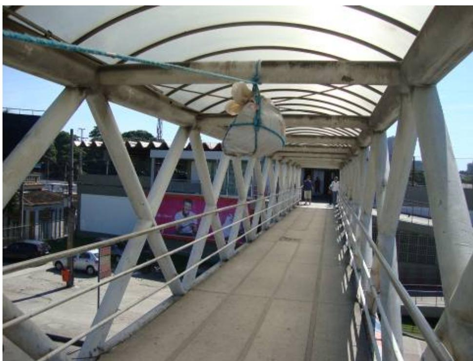
Figura 6.19 – Excitação livre da passarela observa-se a massa de 57 Kg na posição anterior à queda.
