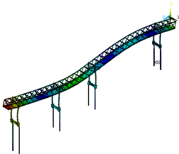
Figura 77 – Modos de vibração do Modelo III relativo à 10ª frequência natural f_{10} : 6,95 Hz.
