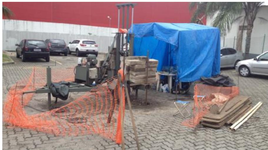
Figura 55 – Ensaio de piezocone sendo realizado no interior do aterro (CPTU-04).
