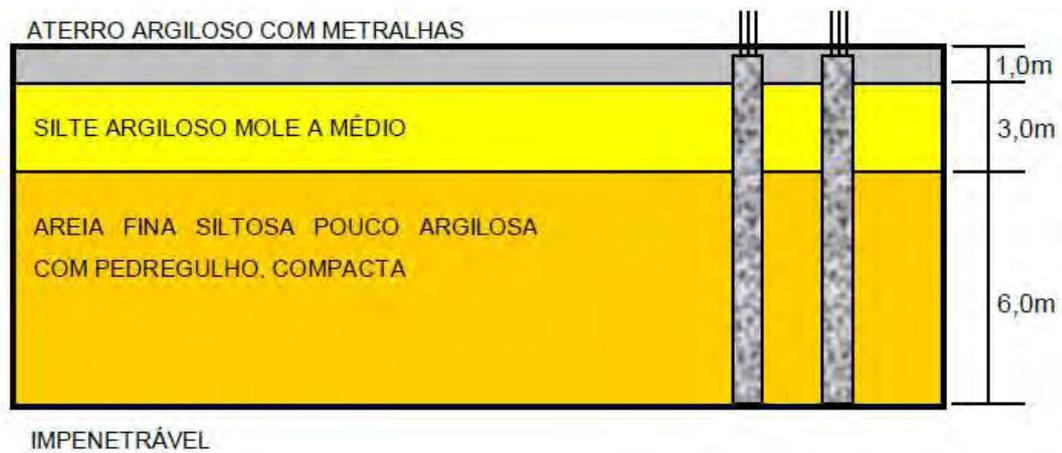
Figura 27 - Perfil geotécnico do solo (Borges, 2009).
